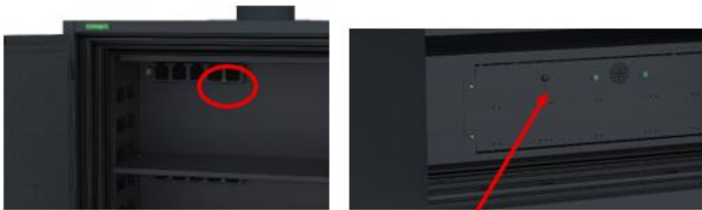
Illustration 1 : voyant vert Illustration 2 : bouton de réinitialisation sur la trappe de service
